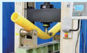
柔軟性に富むポリエチレン製のガス管
