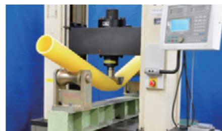
強度に優れたポリエチレン製のガス管
