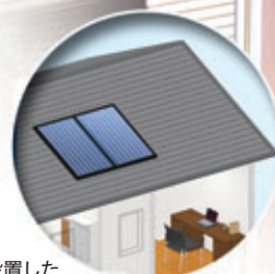
屋根に設置した 集熱パネルで太陽光を利用
