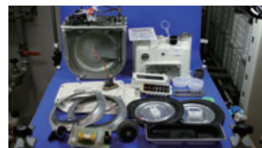
ガスメーターを分解・整備・検査してリユース
