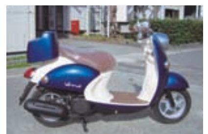
大阪ガスの吸着式バイオガスタンクを利用したガスバイク (バイクメーカー試作)
