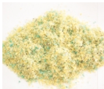
継ぎ手類から分離されたポリエチレン部分
