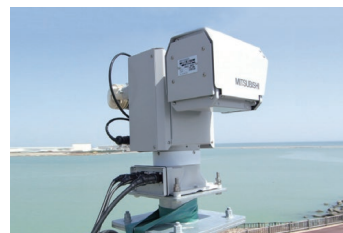
津波監視カメラ
