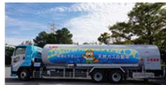
LNG tanker truck fueled by CNG
