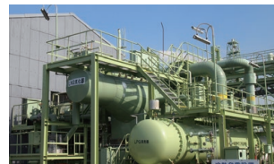
LNG cryogenic power generation facilities at Senboku LNG Terminal
